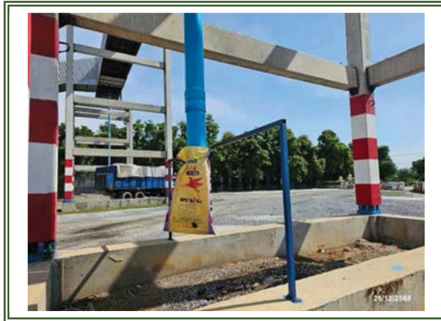
รูปที่ 3-12 ตู้กระสอบขนาดใหญ่รองรับเศษวัสดุที่ตก หล่นจากสายพานลำเลียง
